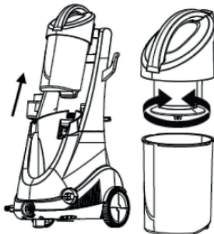
Fig. 21 – Vaciado el recipiente del aspirador
