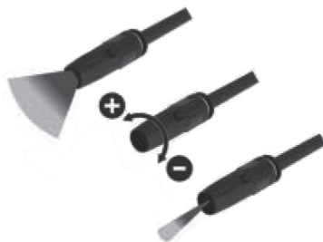
Fig. 11 – Ajuste del abanico del chorro
